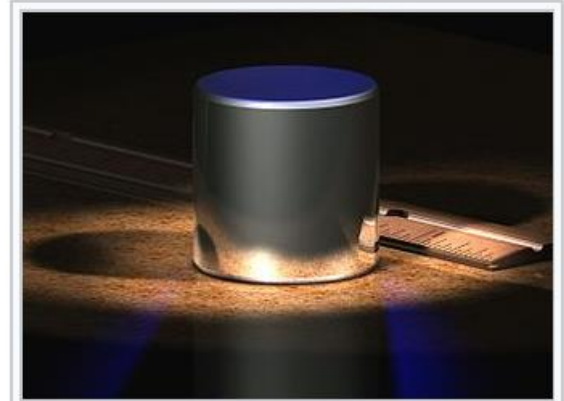
Přibližná podoba mezinárodního prototypu kilogramu
